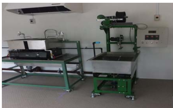
工房に設置した鍋繭煮機、太織度低張力生糸繰糸機
